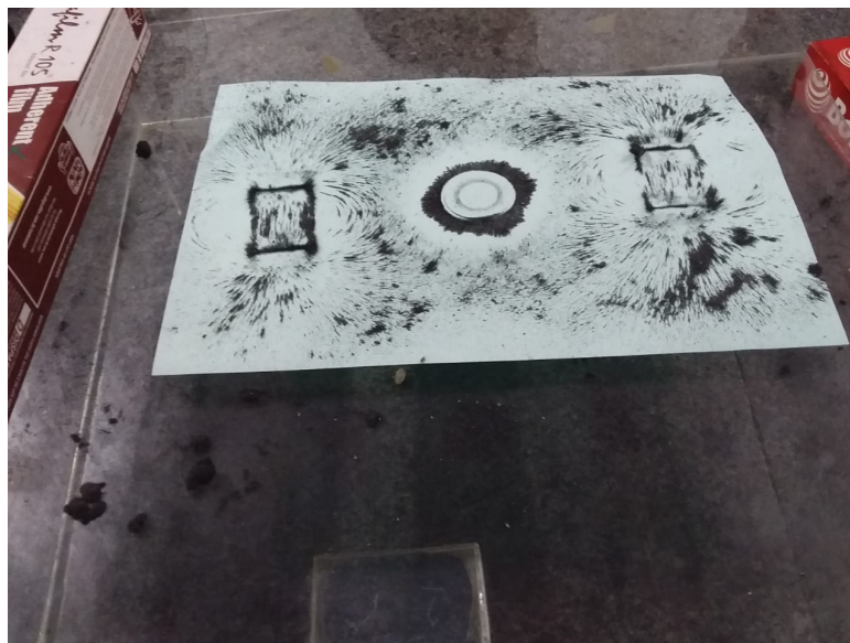
Figura 47 – Configuração da limalha de ferro sendo atraída por ímãs (tipo permanente).
