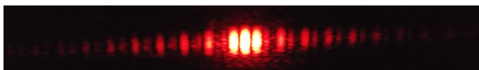
Figura 37 – Padrão de difração gerado em experimento com duas fendas de largura 0,2 mm e distância de 0,2 mm entre elas
