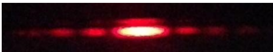
Figura 31 – Padrão de difração gerado em experimento com fenda simples de largura 0,1 Fonte: Os autores
