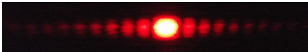
Figura 23 – Padrão de difração gerado em experimento com fenda simples de largura 0,3 Fonte: Os autores
