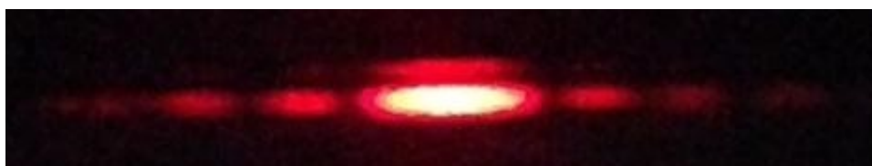
Figura 19 – Padrão de difração gerado em experimento com fenda simples de largura 0,1 Fonte: Os autores
