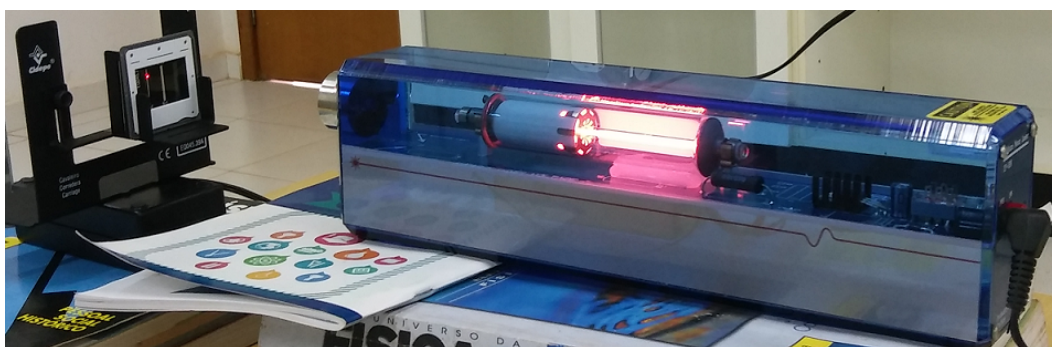
Figura 27 – Demonstração do laser HeNe incidindo sobre a fenda para geração do padrão de difração
