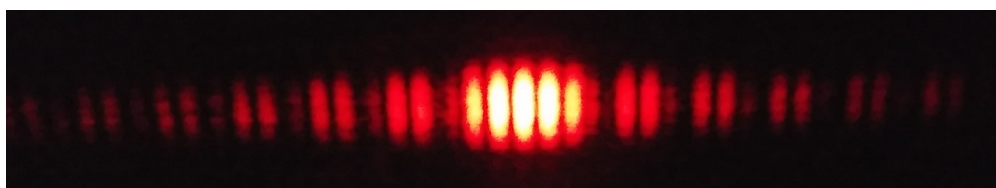
Figura 39 – Padrão de difração gerado em experimento com duas fendas de largura 0,2 mm e distância de 0,4 mm entre elas
