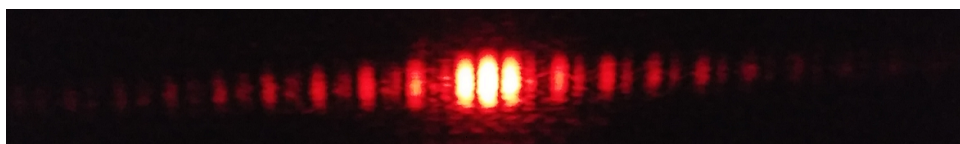
Figura 25 – Padrão de difração gerado em experimento com duas fendas de largura 0,2 mm e distância de 0,2 mm entre elas
