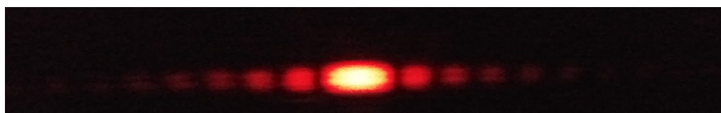
Figura 21 – Padrão de difração gerado em experimento com fenda simples de largura 0,2 Fonte: Os autores
